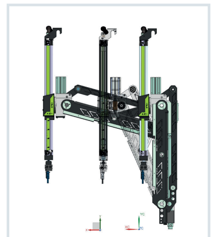
Bild 3. Die Dreieckskinematik wandelt die vertikale Antriebsbewegung in eine horizontale, lineare Entformbewegung um © Engel
